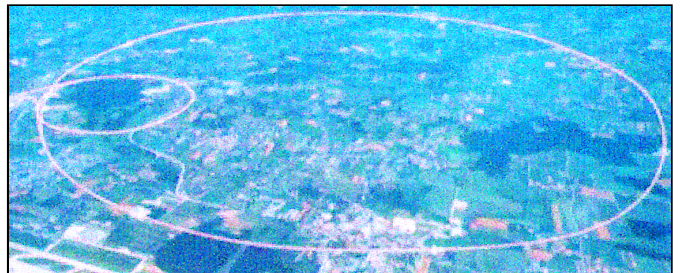
Collisionneurs du Cern – Le grand cercle correspond au site du collisionneur à électron-positron (LEP), enfoui à une profondeur de 100m et décrivant un anneau de 27km de circonférence. Le petit cercle traduit l'emplacement du collisionneur à proton-antiproton.
